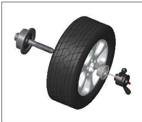
Montaż typu: koło – stożek – nakrętka szybkomocująca. (zalecane dla felg stalowych)
