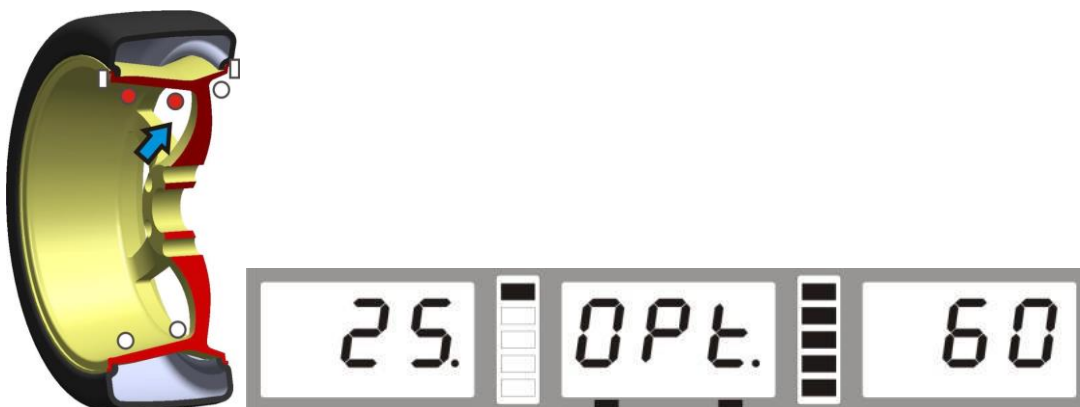
Ilustracja wyświetlacza wskazująca gdzie należy nakleić ciężarek po stronie zewnętrznej felgi.
