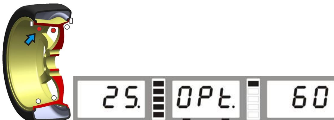
Ilustracja wyświetlacza wskazująca gdzie należy nakleić ciężarek po stronie wewnętrznej felgi.
